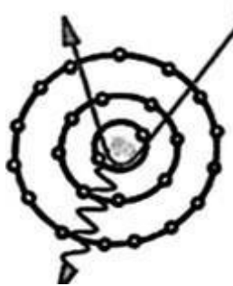
Gambar 2.1 Pembentukan Sinar-X Bremsstrahlung (Lestari, 2019)
